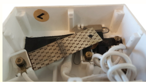
约 1970 年，在英国发热毛毯上的 GEC 功率设定（通用电气，英国）。预期的电阻在双金属和慢的断路器的上方清晰可见。（Ultimheat 收集）
