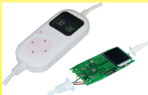
2019 年的控制器，用于带数字显示的温度控制的发热毛毯，通过将一个热敏电阻探头装入受热区域进行操作（Ultimheat 收集）
