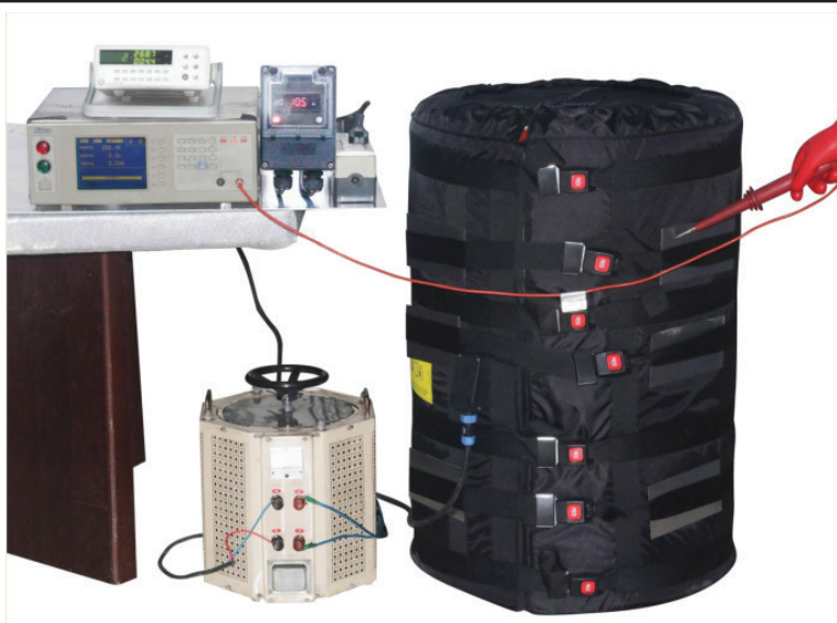
在热条件下总电流泄漏的测量设备
