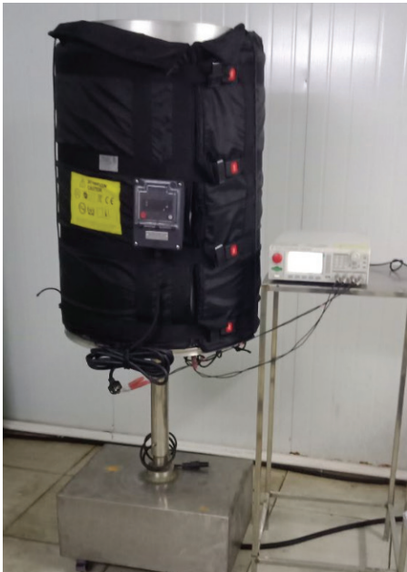
IPx6 测试后的绝缘电阻测量
