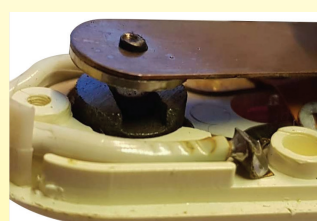
约 1972 年。在利摩日由 Jidé 制造的品牌为 Jidéstat 的电源控制箱。是所有系统中最成功的。尺寸非常小，它是可调节的，并且是合并到电插头里。这是唯一一款带一个速动磁铁触点的型号。直到现在的这个年代，它才被机电系统所超越。（Ultimheat 收集）。
