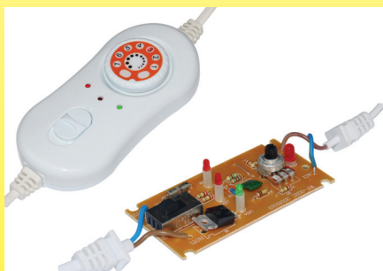
2019 年连续的电子功率控制毛毯控制器（Ultimheat 收集）
