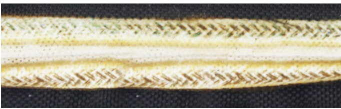
发热电缆在 245^{\circ}C 持续 5 分钟：PA66 已经熔化，并展现了 PTFE 的保护层，其没有变差。发热线的保护经常是通过 PTFE 和硅胶绝缘来完成的。
